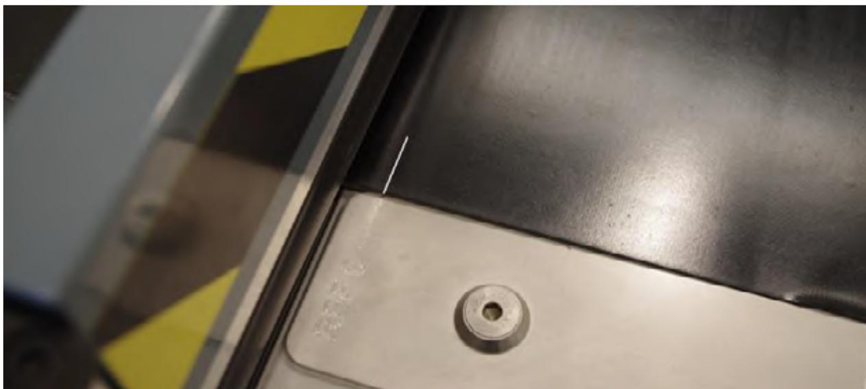
Давление резки необходимо снизить до 2 бар, поскольку во втором процессе происходит резка только верхнего тканевого слоя. Опускаем планку и нажимаем на СТАРТ.
