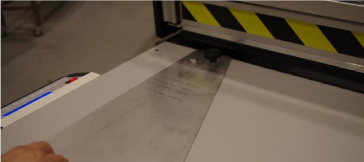
Поместить ленту после резки с диагональю  $70^\circ$  вдоль вспомогательного рельса, чтобы от метки сделать замер с готовым  $80 \times 10 70^\circ$ .
