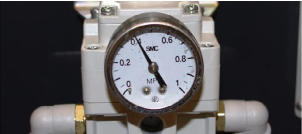
У этого устройства регулировки происходит потеря воздуха для постоянного поддержания точного давления.
