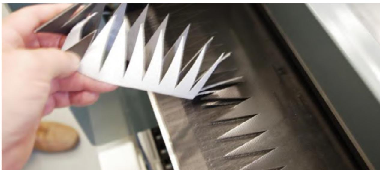
Необходимо поместить противоотсекающую пластину между двух полотен до конца резки инструмента для отслаивания.
