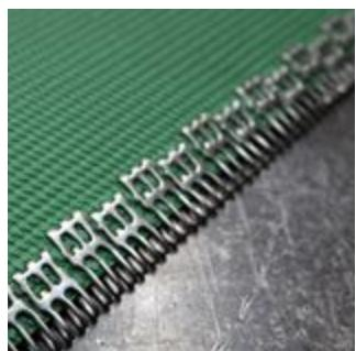
**17** Пересякните сжатый воздух в нерабочем режиме. Выньте установочную ось. Выполните установку на другой стороне ленты. Повторите действия, начиная с этапа 11.
