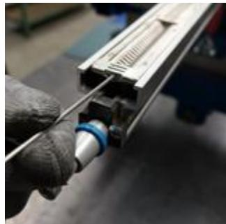
**11** Вставьте установочную ось и снимите картонную подложку соединения.
