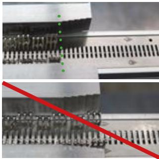
**17** Выровняйте соединение. Ступенчатые края используются только для наращивания длины соединений CL. Не корректируйте расположение соединения в этой зоне.
