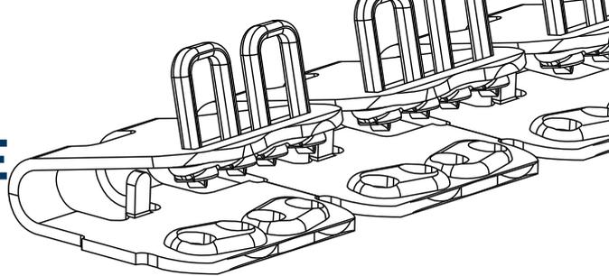
Металлическое соединение на шипах для лёгких конвейерных лент
