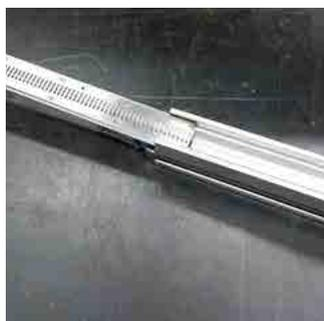
**1|** Установите гребенку Clip'N Lock™ (согласно устанавливаемой модели) в держатель гребенки.
