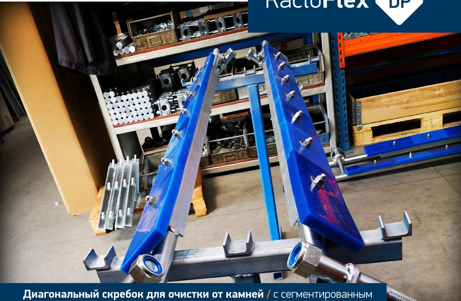
**Диагональный скребок для очистки от камней / с сегментированным лезвием, с автоматическим давлением для двунаправленных лент**
