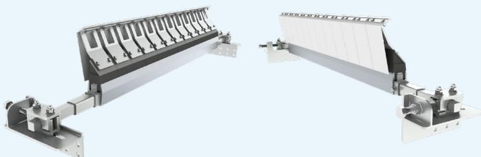
Тяжелая версия **RacloFlex™ NT-HD** предлагается для лент от 1400 до 2200 мм; карбид вольфрама 5x10, алюминиевый профиль опоры и усиленная механическая опора.
