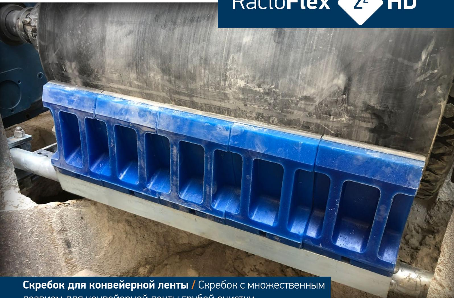
**Скребок для конвейерной ленты / Скребок с множественным лезвием для конвейерной ленты грубой очистки с автоматическим пружинным натяжителем**
